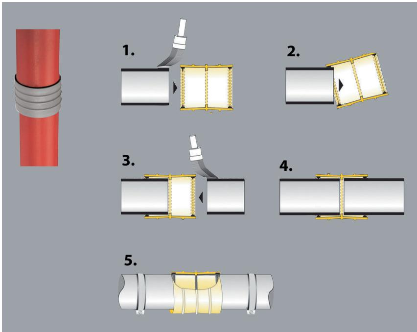
Steckverbindung für Guss-/TML-/BML-Leitungen im Bereich Grundstücksentwässerung und Hausabflussleitungen. Gefertigt entsprechend den amtlichen Bau- und Prüfvorgaben. Doppelmuffe aus PP in grauer Farbe mit direkt angespritzten Lippendiftungen aus TPE. Leichtes, sicheres Montieren, da kein Verrutschen der Dichtung möglich. Bei Verwendung der SVE-Verbinder innerhalb von Gebäuden empfehlen wir aufgrund der Elastizität der Verbindung im Bedarfsfall die Rohre und Formstücke zusätzlich zu sichern.
