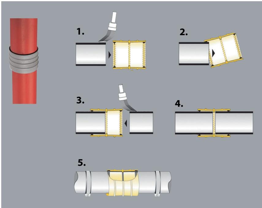
Zástrčkové pripojenie pre liate / TML / BML vedenie v oblasti pozemných a domových kanalizačných potrubí. Vyrobené podľa oficiálnych špecifikácií budovy a testov. Dvojité objímky z PP v šedej farbe s priamo tvarovanými tesneniami pier z TPE. Ľahká a bezpečná montáž, pretože tesnenie nemôže kľať. Pri použití konektora SVE vo vnútri budov odporúčame dodatočne zabezpečiť potrubia a tvarovky, ak je to potrebné kvôli pružnosti spojenia.
