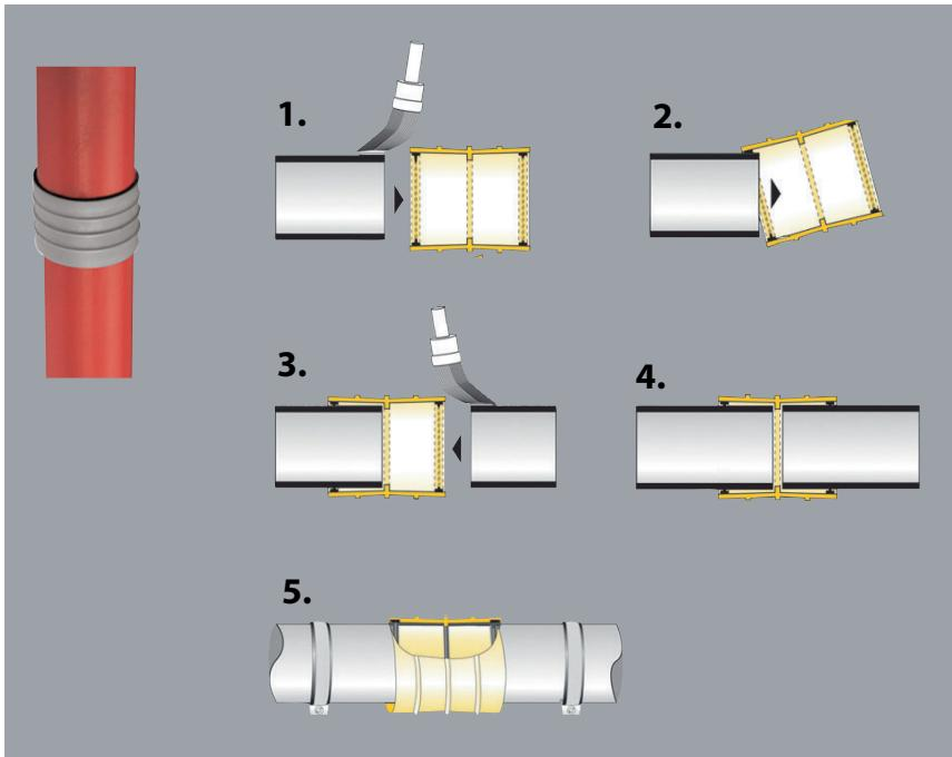
Zástrčkové připojení pro lité / TML / BML potrubí v oblasti kanalizace a domových kanalizací. Vyrobeno podle oficiální specifikace budovy a zkoušek. Dvojitá objímka z PP v šedé barvě s přímo tvarovanými břitovými těsněními z TPE. Snadná a bezpečná montáž, protože těsnění nemůže sklouznout. Při použití konektoru SVE uvnitř budov doporučujeme dodatečně zajistit potrubí tvarovky, je-li to nutné kvůli pružnosti spojení.
