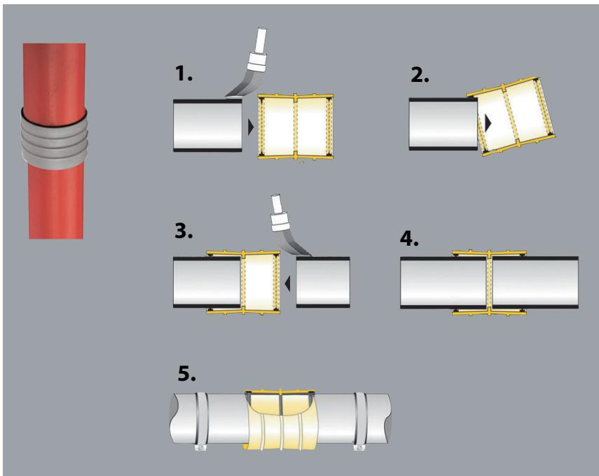
Dugaszoló csatlakozás öntött / TML / BML vonalakhoz az ingatlanelvezetés és a házelvezetési vonalak területén. A hivatalos építési és vizsgálati előírásoknak megfelelően készül. Dupla foglalat PP-ból szürke színben, közvetlenül öntött ajaktömítésekkel, TPE-ból. Könnyű, biztonságos összeszerelés, mivel a tömítés nem csúszhat el. Amikor az SVE csatlakozót épületeken belül használja, javasoljuk a csővek és szerelvények további rögzítését, ha szükséges a csatlakozás rugalmassága miatt.
