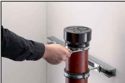
1. Faites glisser l'extrémité ouverte du manchon de raccordement multiple OHA sur l'extrémité du tuyau et positionnez le collier de serrage dans l'évidement prévu à cet effet. Ensuite, serrez fermement le collier de serrage tout en maintenant sa position.
