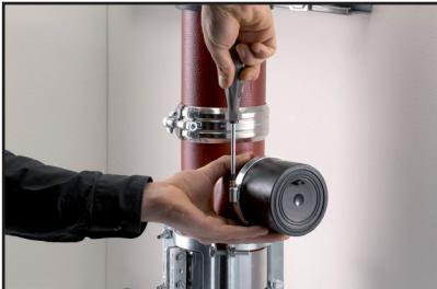
1. Duw het open uiteinde van de OHA verbindingsmof op de SML pijp tot aan de aanslag en maak het vervolgens vast aan de pijp met de slangklem.
